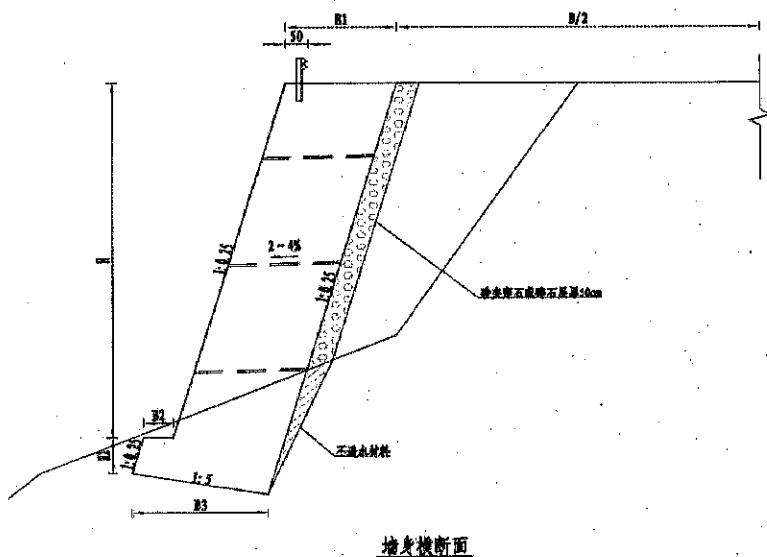
回复：以基底平均埋深1米、两侧1:0.5坡率开挖计量，由于无地勘，实际根据土质情况和设计要求开挖合适深度。
