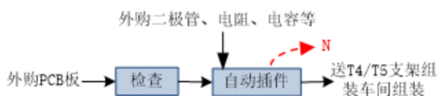
图 2-3 电子镇流器生产工艺及产污节点图
